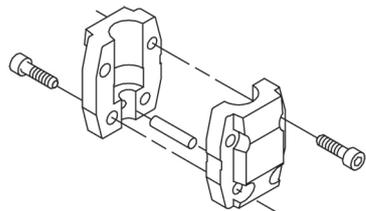
La tête de pompe et la bride de fixation du moteur forment une seule pièce (en fonte). La protection de la tête de la pompe est une pièce séparée (en acier inoxydable). La tête de pompe comporte un bouchon d'amorçage combiné de 1/2" et une vis de purge d'air.
