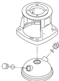
La pompe est équipée d'un joint torique équilibré avec système de transmission de couple rigide. Ce type de garniture est assemblé dans une cartouche, ce qui permet un remplacement simple et en toute sécurité. En raison de l'équilibrage, ce type de garniture est conçu pour les applications haute pression. La construction de la cartouche protège l'arbre de la pompe contre l'usure possible causée par le joint torique dynamique entre l'arbre de la pompe et la garniture mécanique.
